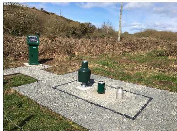
Ffigur 6: Mesurydd glaw yn Nhyddewi, Sir Benfro, sydd wedi cael ei delemetru i gefnogi datblygiad rhagolygon llifogydd gwell yn yr ardal.
